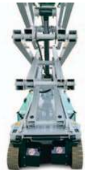
Design del carro base che permette una facile pulizia ed assicura protezione ai componenti
